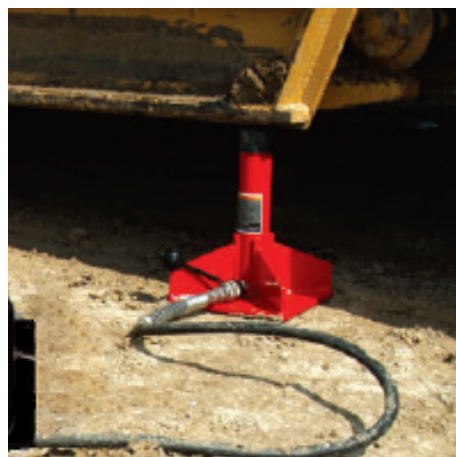
Vérin à simple effet H1506 en position rétractée avec une base de vérin CB15 pour la sécurité.
