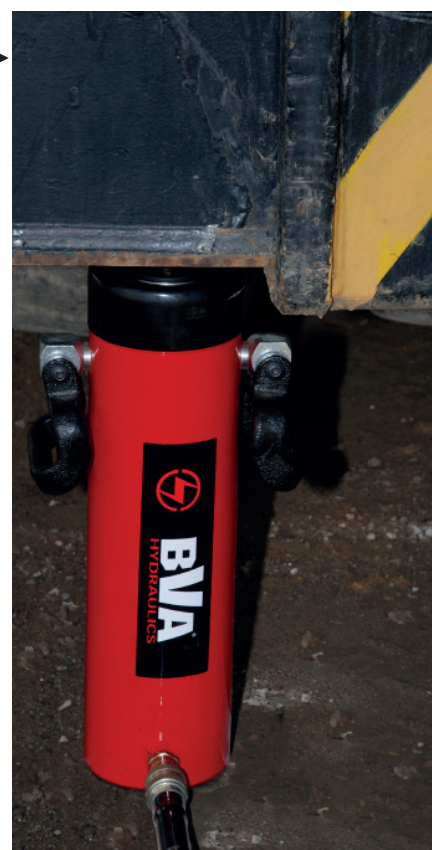
Vérin à simple effet H5513 en position rétractée prêt à soulever une charge.
