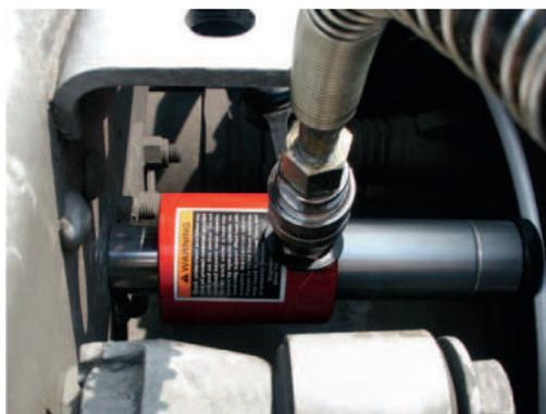
▲ Prend appui sur la roue du camion à partir du moyeu avec la mini-presse. Se place entre le châssis et la roue.
